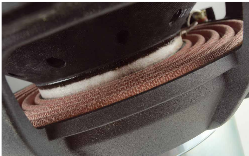
Die Spider wurde per Computer optimiert. Lüftungslöcher sorgen für zusätzliche Kühlung
