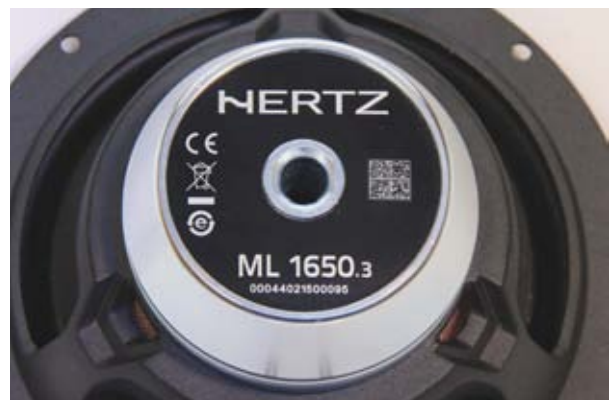
Il QR-Code inciso dal laser sul fondello metallico dell'altoparlante.
