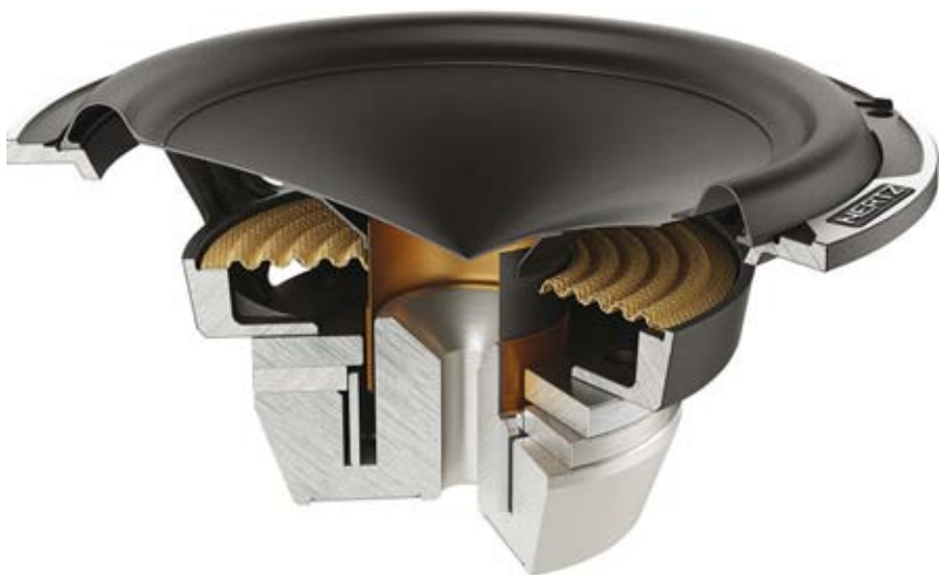
La sezione del woofer mette in evidenza la complessità del gruppo magnetico e la presenza dell'anello in alluminio nella zona esterna del polo centrale.
